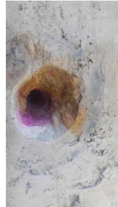
EDIFICIO SCOLASTICO – Indagine su strutture in cemento armato - Analisi degrado – Misure di carbonatazione e corrosione sotto traccia
