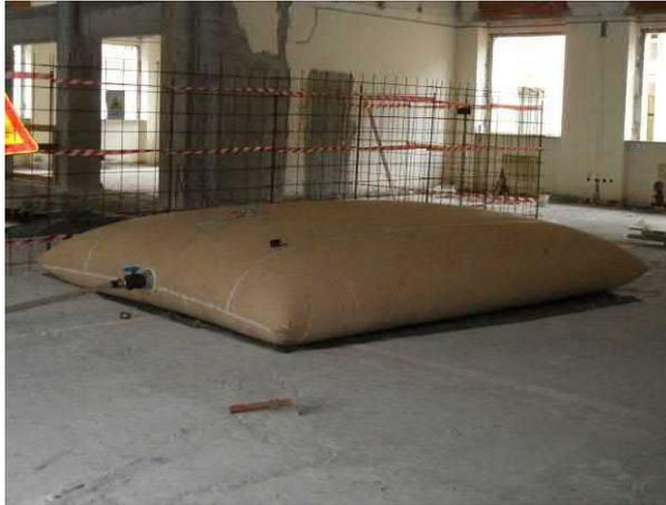
Serbatoio ad acqua per prova di carico
